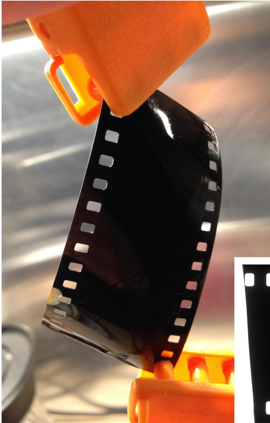
Dernière étape, vidage de la cuve et remplissage à l'eau déminéralisée avec quelques gouttes d'agent mouillant (Ilford Ilfotol).
