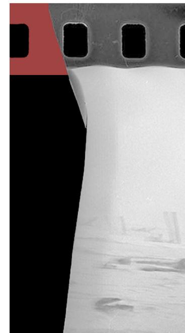
Ces déformations sont caractéristiques d'un défaut de planéité du film. Dans cette zone, le film n'épouse plus la fenêtre d'exposition, et les parties qui s'éloignent de cette dernière sont floues, et celles qui sont encore à son contact restent nettes. Il en résulte une forme en vague, avec des zones floues dans l'image, qui peuvent ressembler à un flou de bougé.
