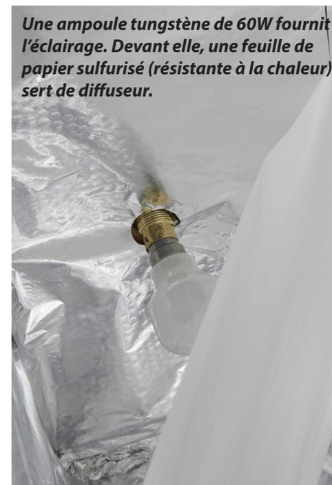
*Une ampoule tungstène de 60W fournit l'éclairage. Devant elle, une feuille de papier sulfurisé (résistante à la chaleur) sert de diffuseur.*
